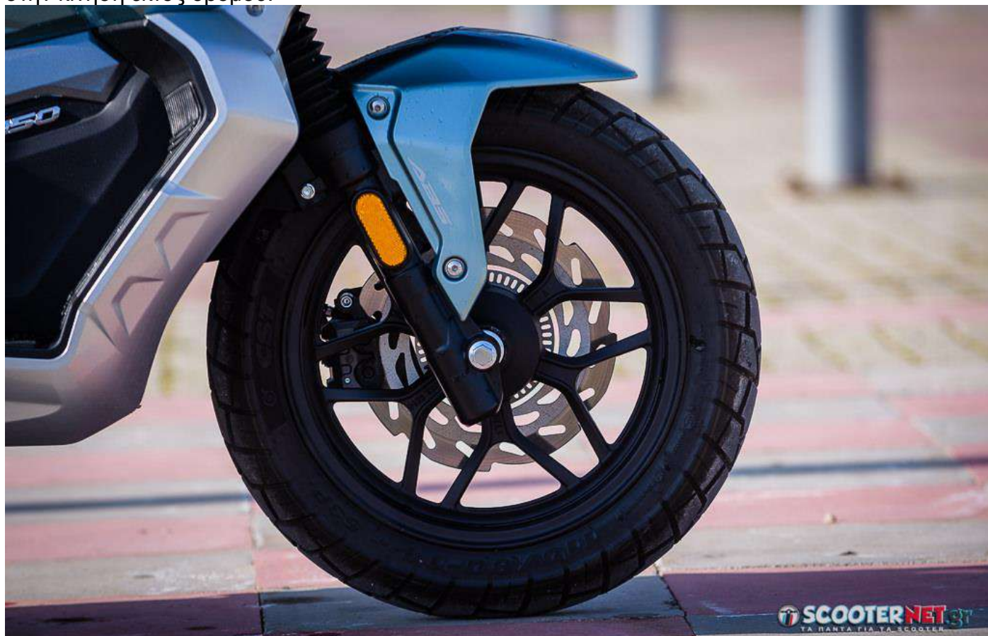
Χυτή μαύρη ζάντα με 10 μπράτσα και φισούνες στα καλάμια του πιρουνιού
